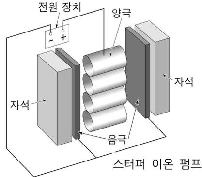
자기장은 전자가 양극까지 이동하는 거리를 자기장이 없을 때보다 증가시켜 주어 전자와 기체 분자와의 충돌 빈도를 높여 준다. 이 과정에서 생성된 양이온은 전기력에 의해 음극으로 당겨져 음극에 박히게 되어 이동 불가능한 상태가 된다. 이 과정이 1차 펌프 작용이다. 또한 양이온이 음극에 충돌하면 타이타늄이 떨어져 나와 충돌 지점 주변에 둘러붙는다. 이렇게 둘러붙은 타이타늄은 높은 화학 반응성 때문에 여러 기체 분자와 쉽게 반응하여, 떠돌아다니던 기체 분자를 흡착한다. 이는 떠돌아다니는 기체 분자의 수를 줄이는 효과가 있으므로 이를 2차 펌프 작용이라 부른다. 이렇듯 1, 2차 펌프 작용을 통해 스퍼터 이온 펌프는 초고진공 상태를 만들 수 있다.
